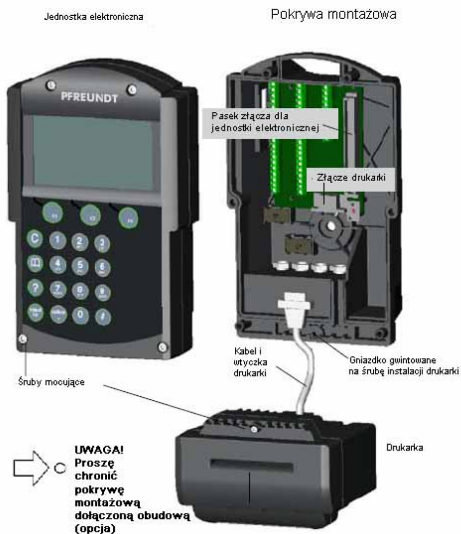
Rysunek 012/03/02 Instalacja usunięcie
